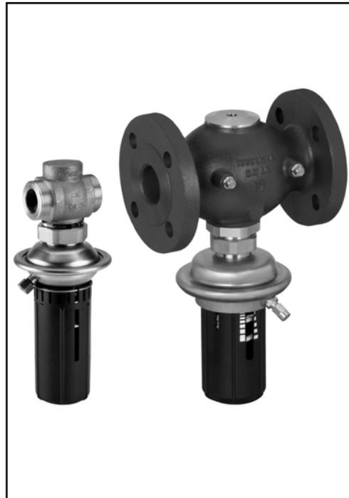
Регулятор представляет собой автоматический регулятор перепада давления, предназначенный, главным образом, для систем централизованного теплоснабжения. При повышении перепада давления регулятор закрывается.
